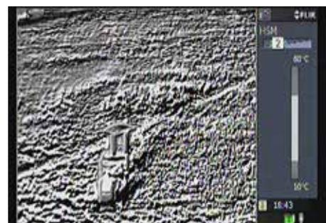
Durante il volo di test con un drone, la FLIR G300a ha rilevato con estrema precisione la fuoriuscita di gas da una bombola collocata a terra (in alto: modalità termica, in basso: modalità HSM).
