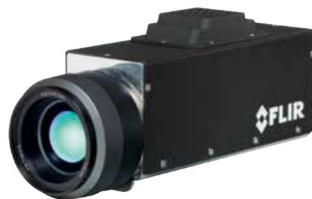
La termocamera per la rilevazione ottica di gas FLIR G300a è dotata di un sensore ad Antimoniuro di Indio (InSb) raffreddato, in grado di generare immagini termiche a 320 x 240 pixel.
